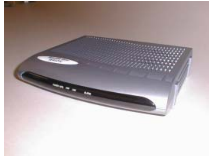
宅用ADSL装置(CPE) 製品名: TE4111C (1.5Mbps専用モデル) TE4121C (1.5/8Mbps両用モデル)
